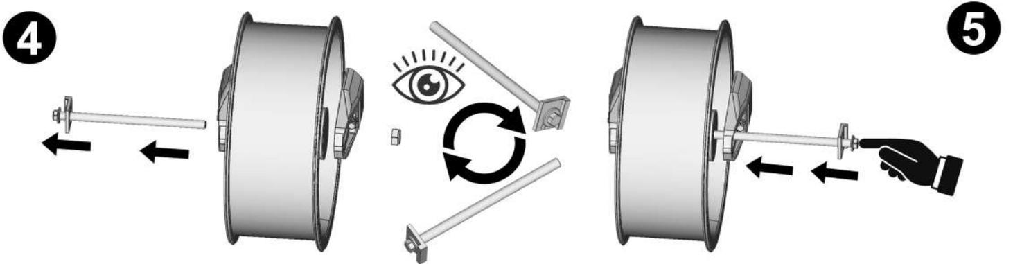
Inverser le sens d'insertion de l'axe de roue **SI NÉCESSAIRE** / Reverse the wheel axle direction **IF NECESSARY**
