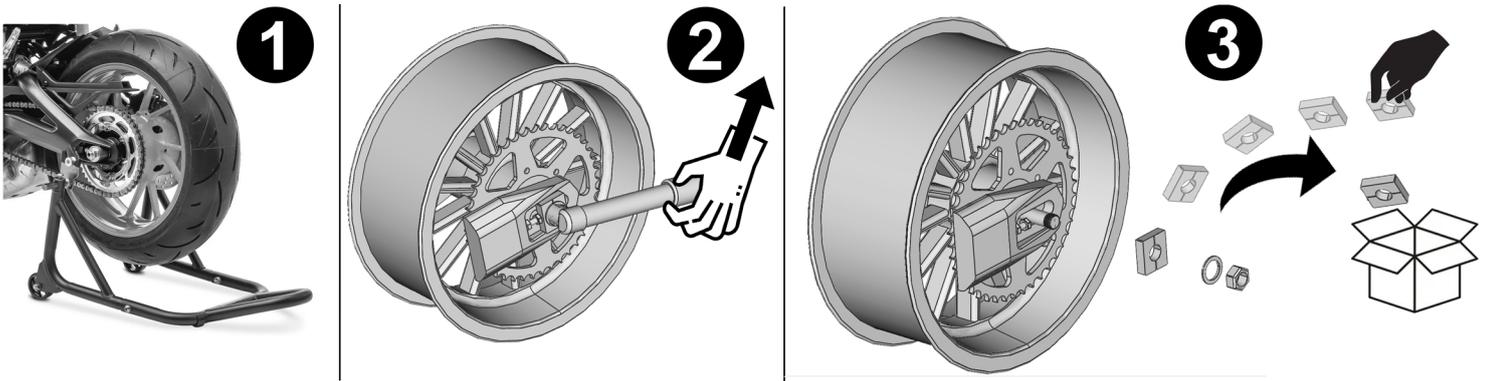
Si nécessaire, inverser le sens d'insertion de l'axe de roue / If necessary, reverse the wheel axle direction
