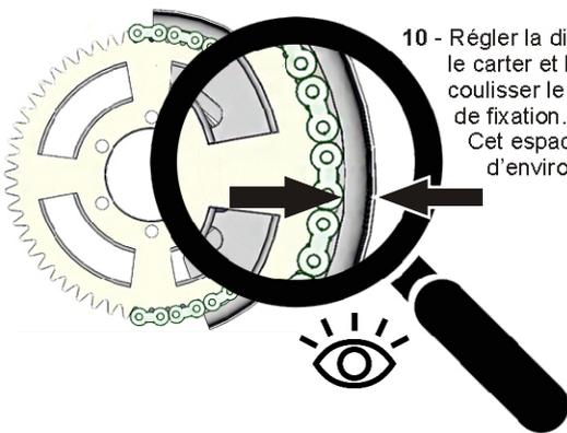
10 - Régler la distance entre le carter et la chaîne en faisant coulisser le carter sur la chape de fixation. Cet espace doit être d'environ 10mm.
