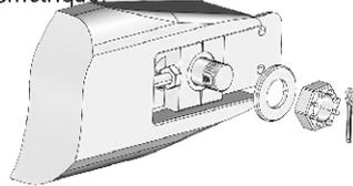
8 - Procéder à l'assemblage des pièces comme décrit sur le schéma, en approchant la visserie **SANS bloquer**, le carter doit pouvoir bouger tout en gardant la position.
