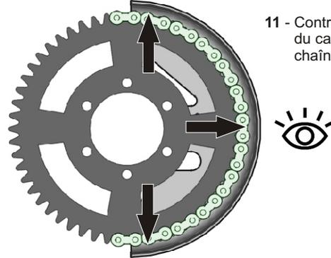
11 - Contrôler et ajuster le centrage du carter par rapport à la chaîne (environ 10mm).
