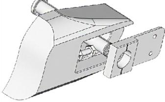
7 - Remonter l'ensemble rondelle, écrou et goupille, puis serrer l'écrou d'axe de roue au couple préconisé par le constructeur, à l'aide d'une clé dynamométrique.
